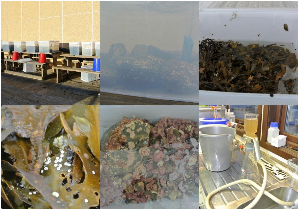
Figur 10, Vannfiltrering fra akvarier ved Kvalfjorden, Hammerfest, Finnmark. Øverst til venstre vises akvariene med luftpumper skjult under bøttene (som beskyttelse mot regn). Bildene 2-5 sett fra topp, venstre viser eksemplere på biologisk materiale som var til stede i akvariene og siste bilde (nederst til høyre) viser hvordan vannet ble filtrert.
